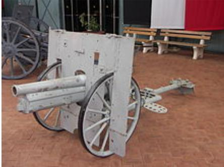
Rheinmetall entwickelte 1891 nahtlose Rohre und 1896 das weltweit erste ‚felddiensttaugliche‘ Rohrrücklaufgeschütz (ein Schnellfeuergeschütz mit veränderlichem Rücklauf und kombinierter Rücklauf- und Vorholvorrichtung) und erzielte damit erheblichen wirtschaftlichen Erfolg: Aufträge der britischen Armee, Norwegens, Österreichs und der USA.
